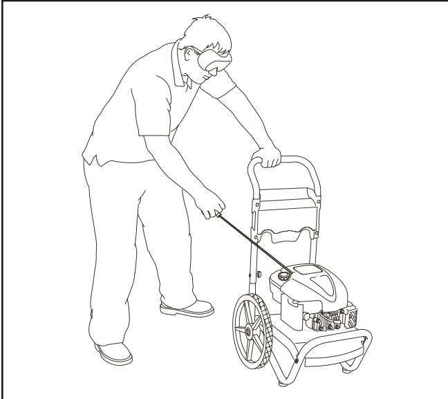
Figura 37 - Posición Recomendada para el Arranque
